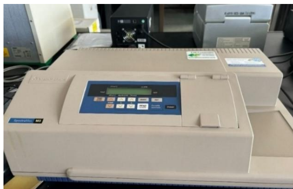
รูปภาพที่ 12 วิเคราะห์ปริมาณฟีนอลิกรวม และฤทธิ์ต้านอนุมูลอิสระ ABTS DPPH โดยใช้เครื่องสเปกโตรมิเตอร์
