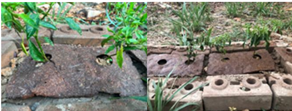
รูปที่ 10 แผ่นคลุมดินย่อยสลายได้จากวัสดุชีวมวล
