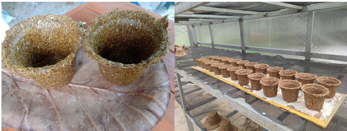
รูปที่ 8 บรรจุภัณฑ์สำหรับเพาะกล้าไม้ (กระถาง) จากใบไม้ที่ไม่ได้สับย่อย แบบอัดเย็น
