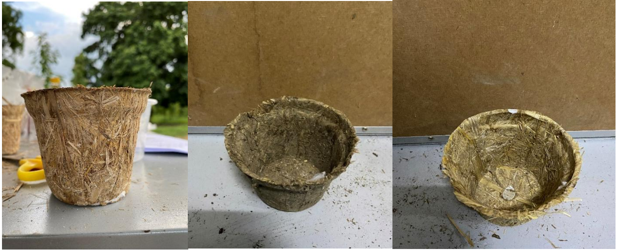
รูปที่ 7 บรรจุภัณฑ์สำหรับเพาะกล้าไม้ (กระถาง) จากใบไม้ที่ไม่ได้สับย่อย แบบอัดร้อน
