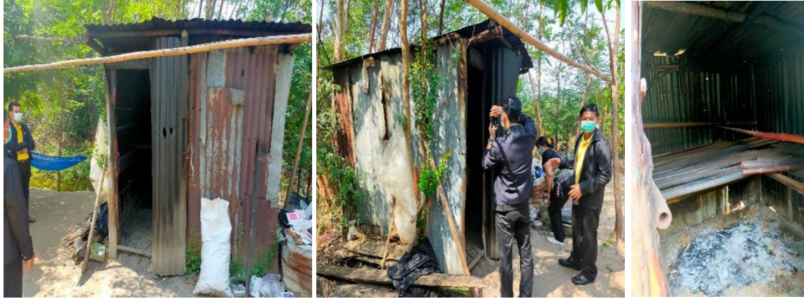
รูปที่ 3 แสดงเตาอบรมควัน ผลิตภัณฑ์เครื่องจักสาน
