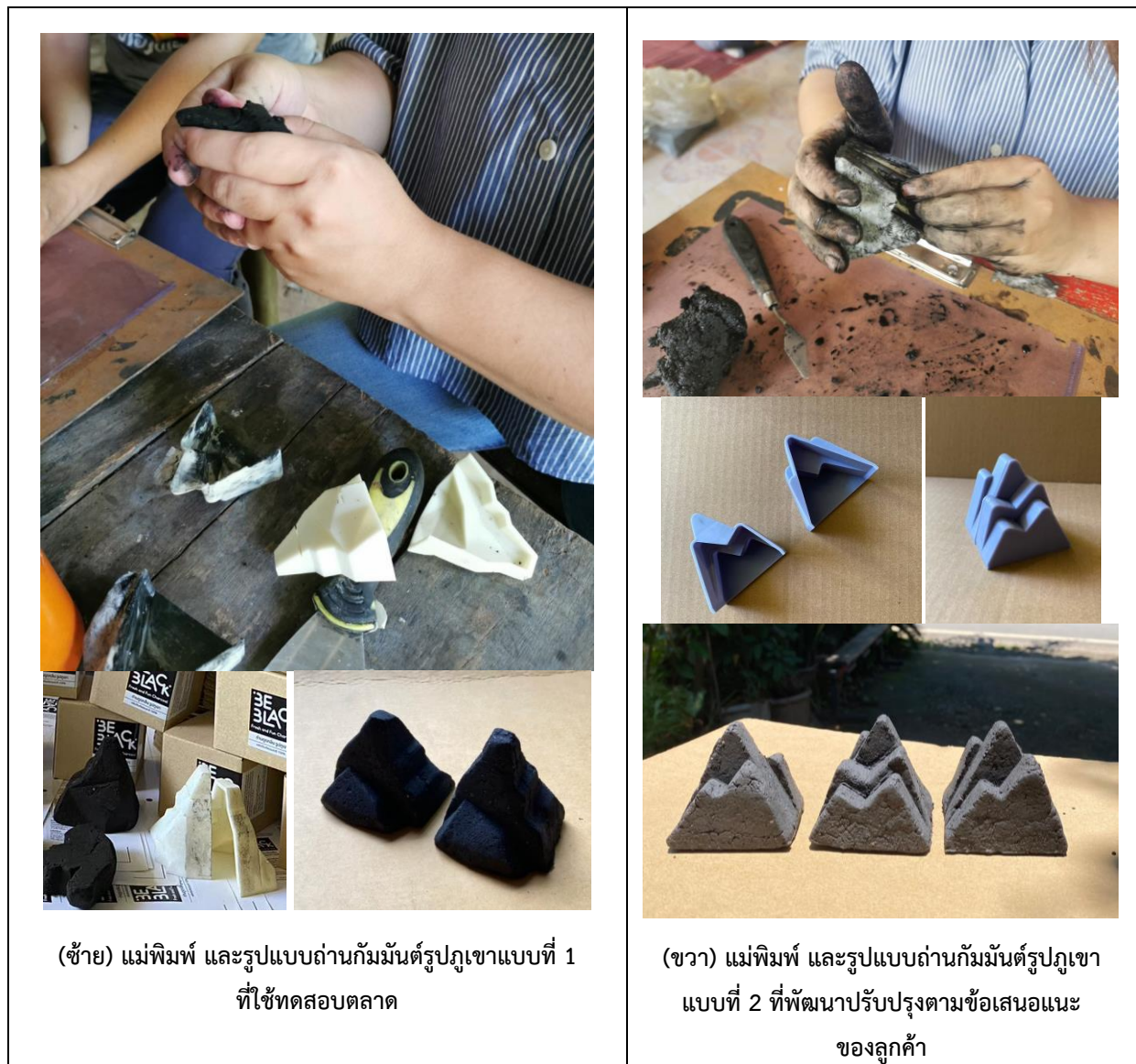
ภาพที่ 9 แสดงภาพแม่พิมพ์และการขึ้นรูปถ่านกัมมันต์รูปภูเขาแบบที่ 1 และ แบบที่ 2
