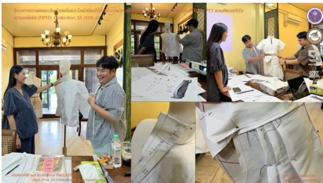
ภาพที่ 2.29 การทดลองขึ้นรูปแพทเทิร์นบนหุ่นและการปรับแก้แพทเทิร์นร่วมกับผู้ประกอบการ ที่มา: คณะผู้ดำเนินโครงการ (2569)
