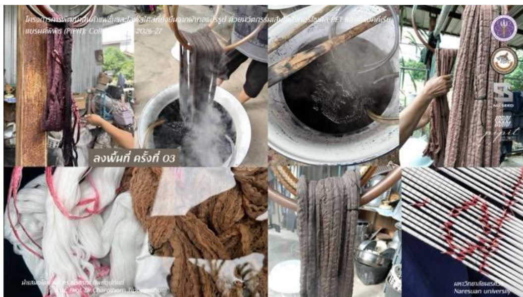
ภาพที่ 2.32 การลงพื้นที่ครั้งที่ 3: การย้อมสีเส้นใยสำหรับการผลิตผ้าทอนวัตกรรม ที่มา: คณะผู้ดำเนินโครงการ (2569)
