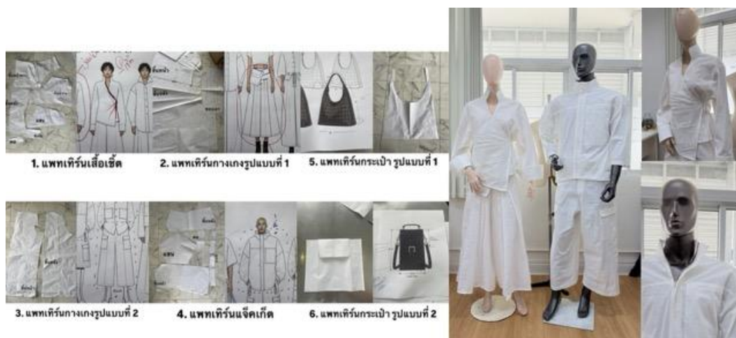
ภาพที่ 2.37 แพทเทิร์นสำหรับการผลิต 6 รูปแบบ ได้แก่ เสื้อเชิ้ต กางเกง 2 รูปแบบ แจ็กเก็ต และกระเป๋าส 2 รูปแบบ พร้อมชิ้นงานตัวอย่างจากผ้าดิบ (Toile) บนหุ่น ที่มา: คณะผู้ดำเนินโครงการ (2569)
