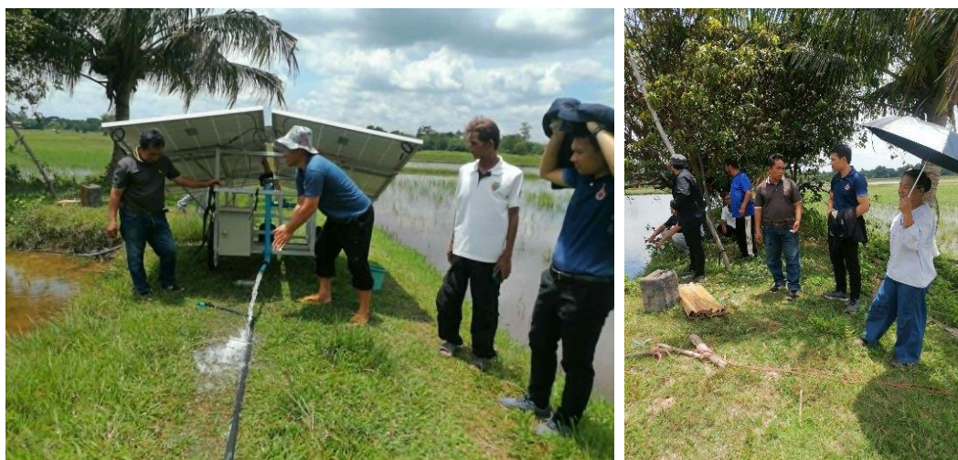
ภาพที่ 2.16 ผลการใช้งานและการทดสอบเครื่องสูบน้ำพลังงานโซลาร์เซลล์เคลื่อนที่ในพื้นที่ของสมาชิกกลุ่มผู้ประกอบการเพาะเลี้ยงสัตว์น้ำ
