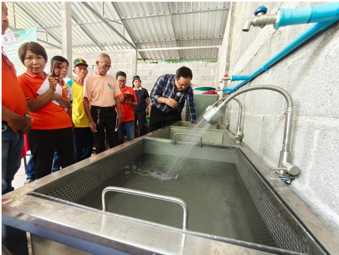
ภาพที่ 2.9 การล้างสมุนไพรด้วยระบบฉีด 3 น้ำ
