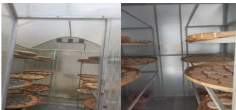
ภาพที่ 1.8 การใช้งานโรงอบแห้งขนมนางเล็ดด้วยพลังงานแสงอาทิตย์และพลังงานชีวมวล
