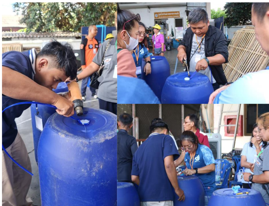
ภาพที่ 8 การปิดเชื่อมรอยข้อต่อเชื่อมสำหรับท่อส่งก๊าซชีวภาพ
