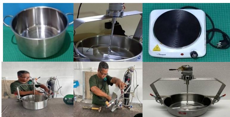
ภาพที่ 19 การออกแบบและจัดทำเครื่องวัดความชื้นไต้ปลาแห้ง (ก) หม้อสแตนเลส (ข) ชุดกวนพร้อมใบพาย (ค) เตาไฟฟ้า (ง) เครื่องวัดความชื้นไต้ปลาแห้ง
